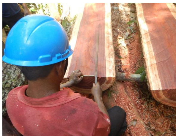
Figura 4 – Manejador medindo peça de madeira serrada (Fonte: arquivo IFT).
